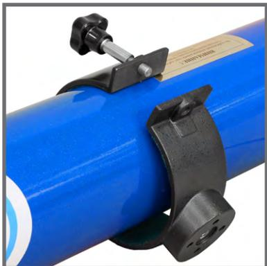
**2.** Освободите оптическую трубу ТАЛ-75R от экваториальной монтировки. Для этого выкрутите полностью винт 1 (Фото) хомута и поверните верхнюю часть хомута, удерживающий оптическую трубу в монтировке.
