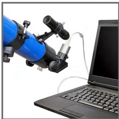
**10.** Установите в персональном компьютере программное обеспечение для телевизионной камеры с диска CD-ROM. Соедините телевизионную камеру и персональный компьютер кабелем из комплекта камеры. Изображение центра перекрестия искателя должно находиться в центре экрана монитора.
