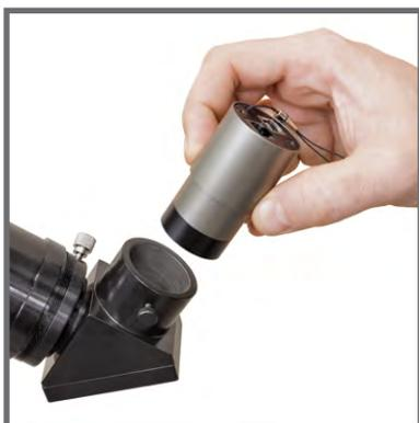
**9.** Установите телевизионную камеру TopCam GCMOSO1200KPB в оптическую трубу вместо окуляра как изображено на фото.
