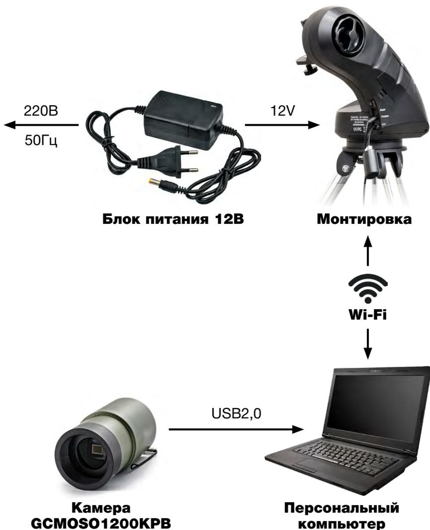
Все соединения производятся кабелями, входящими в комплекты поставки составных частей телескопа.
